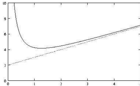
25. An eine Stromquelle mit dem Innenwiderstand  $R_i$  wird ein Verbraucher mit dem Widerstand  $R$  angeschlossen.  $P$  sei die im Verbraucher umgesetzte Leistung.
