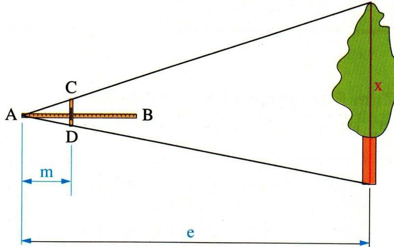
Die obigen Bilder zeigen in zeitgenössischen Darstellungen aus dem 16. Jahrhundert den Gebrauch des Jakobsstabs. Dieser ist ein kreuzförmiges Holz mit verschiebbarer Vertikalen. Beispielsweise wurde die Entfernung zwischen zwei Punkten (Stern und Mond) mit diesem Gerät angenähert ermittelt.
