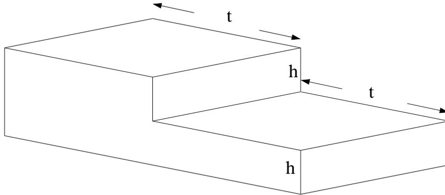
„Die magische Zahl für Treppen lautet 63 Zentimeter. So viel beträgt das Schrittmaß, das für eine gute Begehbarkeit steht. . . . Das Schrittmaß errechnet sich nach folgender Formel: Zweimal die Stufenhöhe  $h$  plus einmal die Stufentiefe  $t$  gleich 63 Zentimeter.“
