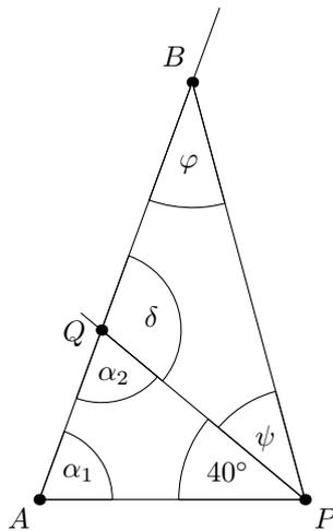
(b) Die beiden Dreiecke  $APQ$  und  $QPB$  sind gleichschenkelig:  $\overline{AP} = \overline{PQ} = \overline{QB}$ .
