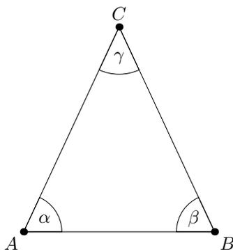
In einem gleichschenkligen Dreieck haben die beiden Basiswinkel gleiches Maß. In der Figur gilt also:  $\alpha = \beta$ .
