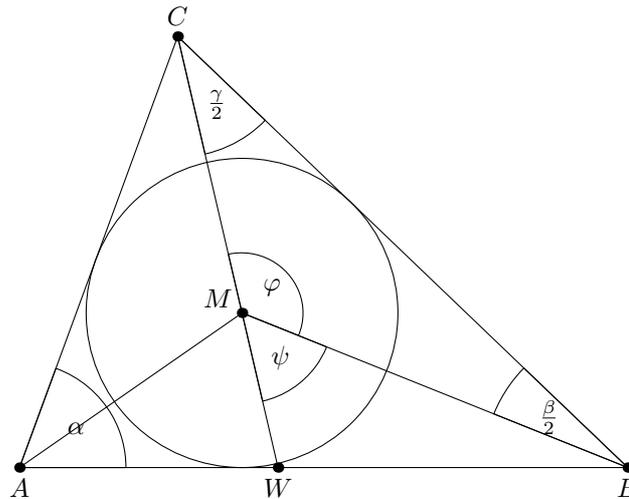
Der Winkel mit dem Maß  $\psi$  ist ein Außenwinkel am Dreieck  $MBC$ :  $\Rightarrow \psi = \frac{\beta}{2} + \frac{\gamma}{2}$ .
