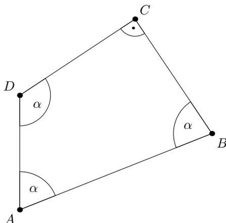
$$\text{Es gilt: } \alpha + \alpha + \alpha + 90^\circ = 360^\circ \Leftrightarrow 3 \cdot \alpha + 90^\circ = 360^\circ \Leftrightarrow \alpha = 90^\circ.$$
