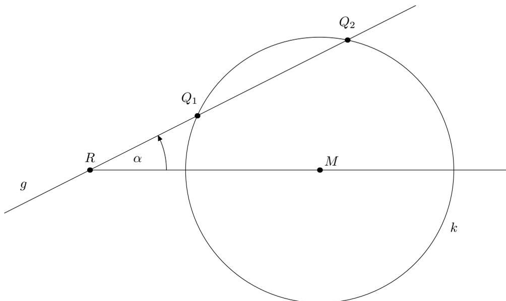
Die Gerade  $g$  durch den Punkt  $R$  schneidet die Kreislinie  $k$  in den Punkten  $Q_1$  und  $Q_2$ .
