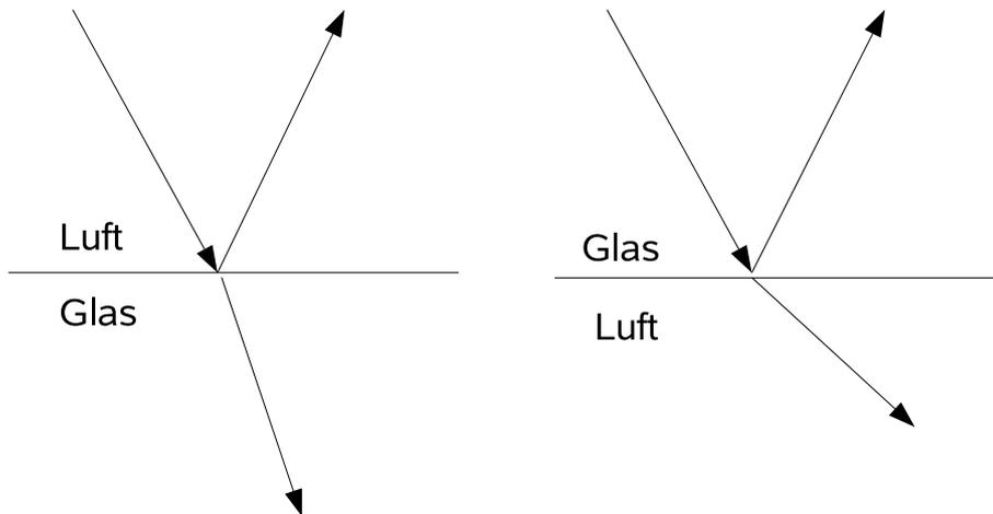
An jeder Grenzfläche tritt Reflexion auf. Beim Übergang von Luft nach Glas (dichteres Medium) wird der Strahl zum Lot hin gebrochen. Beim Übergang von Glas (dichteres Medium) nach Luft wird der Strahl vom Lot weg gebrochen. Wird dabei der Grenzwinkel überschritten gibt es keinen gebrochenen Strahl mehr (Totalreflexion).
