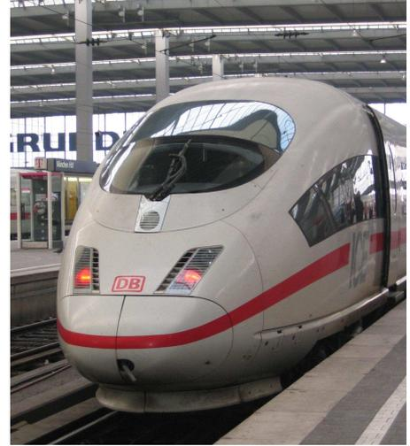
*Lösung:*  $a = \frac{F}{m} = \frac{3,0 \cdot 10^5 \text{ N}}{4,05 \cdot 10^5 \text{ kg} + 415 \cdot 75 \text{ kg}} = 0,69 \frac{\text{m}}{\text{s}^2}$
