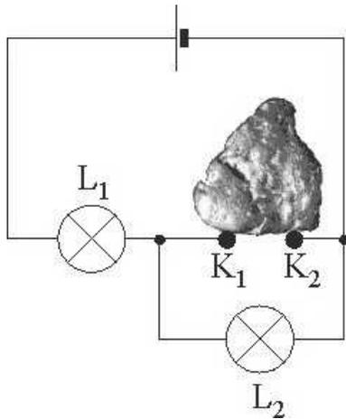
Grundprinzip: Man benutzt den Goldklumpen als Schalter. Er überbrückt die beiden Kontakte  $K_1$  und  $K_2$ . Wird der Goldklumpen gestohlen ist der Schalter offen. Ist der Goldklumpen vorhanden, so schließt er (als guter elektrischer Leiter) die Lampe  $L_2$  kurz, der Strom fließt durch  $L_1$  und den Goldklumpen. Wird der Goldklumpen gestohlen, so ist kein Leiter zwischen  $K_1$  und  $K_2$ , der Strom fließt durch  $L_1$  und  $L_2$ .
