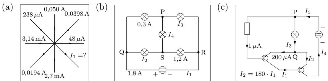
*Lösung:* (a) Zum Knoten:  $I_{\text{hinein}} = (0,238 + 39,8 + 2,7) \text{ mA} = 42,738 \text{ mA}$
