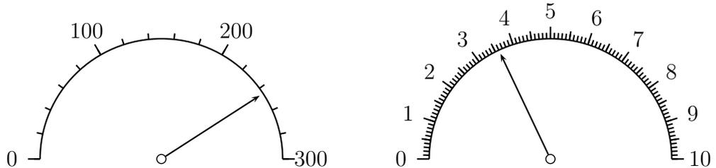
Der Messbereich des Gerätes, das zur linken Skala gehört ist 300 mA und der des Gerätes, das zur rechten Skala gehört ist 10 V. Berechne den Wert des elektrischen Widerstands der Glühbirne.
