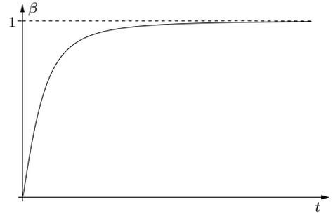
(b)  $t = \frac{p}{eE} = \frac{mc}{eE} \cdot \frac{\beta}{\sqrt{1-\beta^2}} \approx \frac{mc\beta}{eE} = \frac{mv}{eE} = \frac{p_{\text{klassisch}}}{eE}$  für  $\beta \ll 1$
