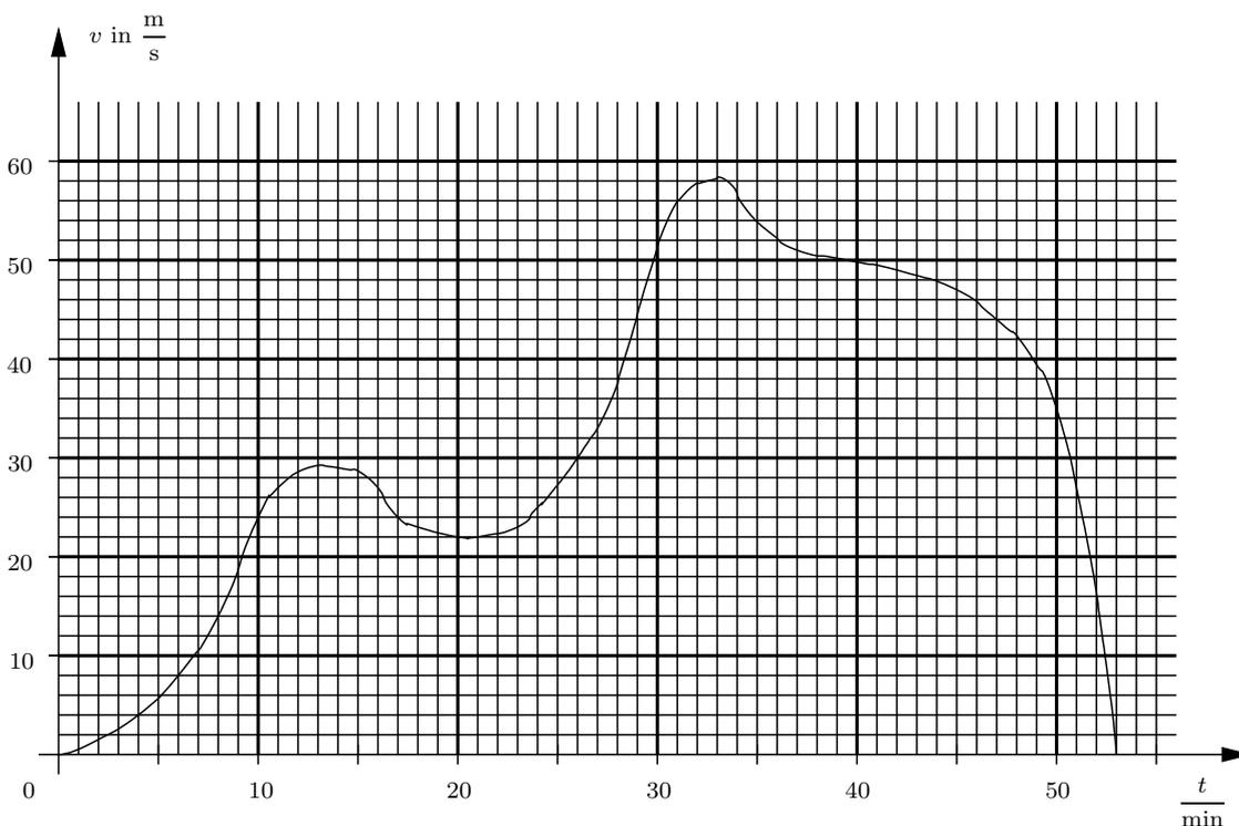
Die Abbildung zeigt das Ergebnis eines Fahrtenschreibers zwischen zwei Tankstops eines PKW's. Beim zweiten Halt wird der anfänglich volle Tank mit 12,3 Litern Benzin wieder ganz aufgefüllt. Gesucht ist der möglichst genaue Benzinverbrauch des Autos auf 100 km.
