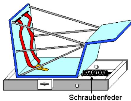
Mit diesem BMMD bestimmen die Astronauten im Spaceshuttle in der Erdumlaufbahn ihre Körpermasse. Es besteht aus einem Gestell, in dem sich die Astronautin mit einem Gurt festgeschnallt hat. Dieses Gestell ist reibungsfrei in einer Schiene montiert und an einer Schraubenfeder befestigt.
