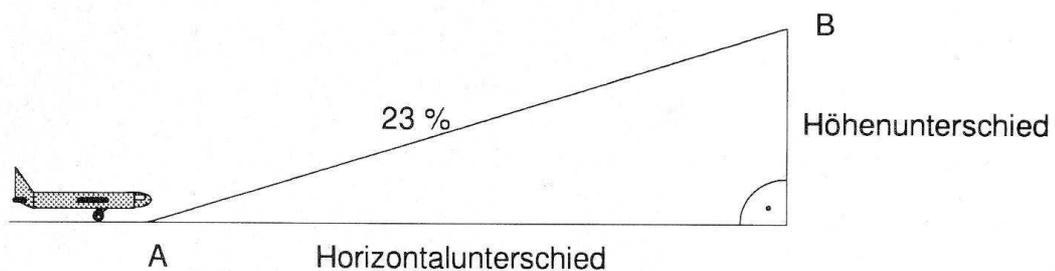
Die Steigung von  $23\% = 0,23$  wird aus dem Quotienten von Höhen- und Horizontalunterschied ermittelt:  $Steigung = \frac{Höhenunterschied}{Horizontalunterschied}$ .
