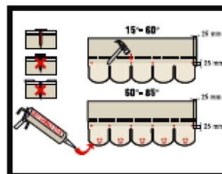
Benützen Sie verzinkte Schindelnägel, Typ Easy Shingle<sup>®</sup> und Bitumenkaltkleber Easy Shingle<sup>®</sup> Stick
